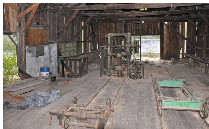
Hala tartaczna w Sułkowicach w trakcie demontażu traka, X 2014 r. (fot. R. Sorek)
